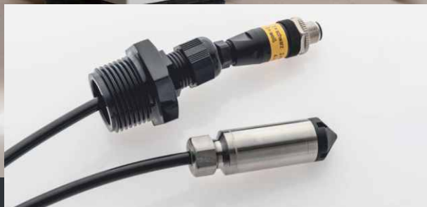
Präzise Drucksonde 0,25 bar | Messbereich bis 250 cm Wassersäule | 5 m Kabel | inkl. 1" Einbaustopfen mit Kabeldurchführung
