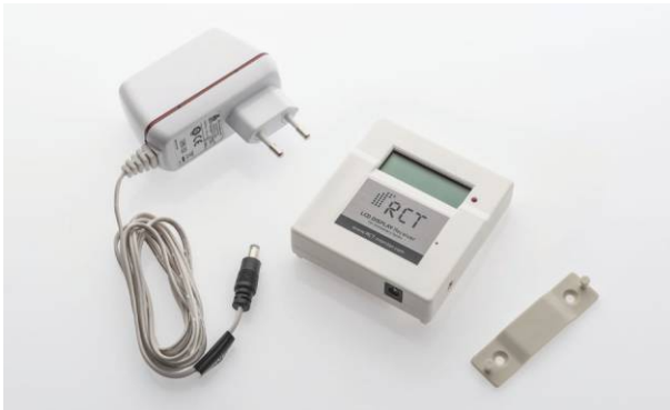
Abb. 9 | LCD-Anzeige mit Netzteil und Wandhalterung
