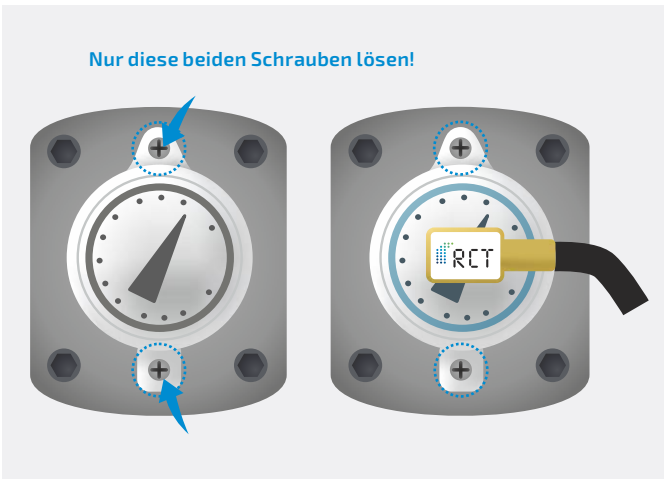
Abb. 2+3 | Originale Anzeigehuhr entfernen und RCT-Sensor einsetzen
