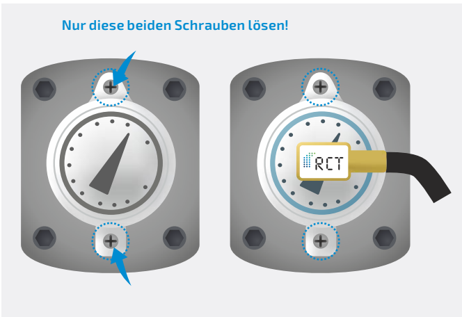
Abb. 2+3 | Originale Anzeigehuhr entfernen und RCT-Sensor einsetzen
