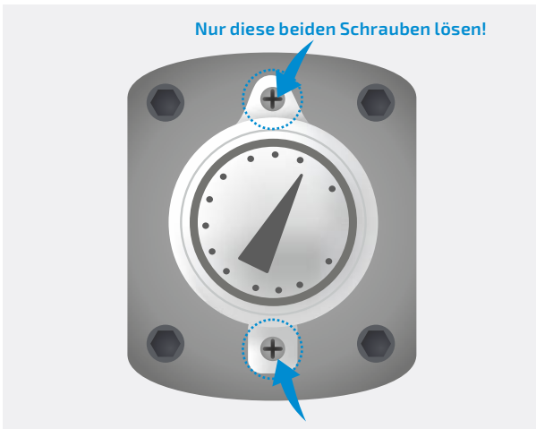
Abb. 2 | Originale Anzeigehuhr entfernen
